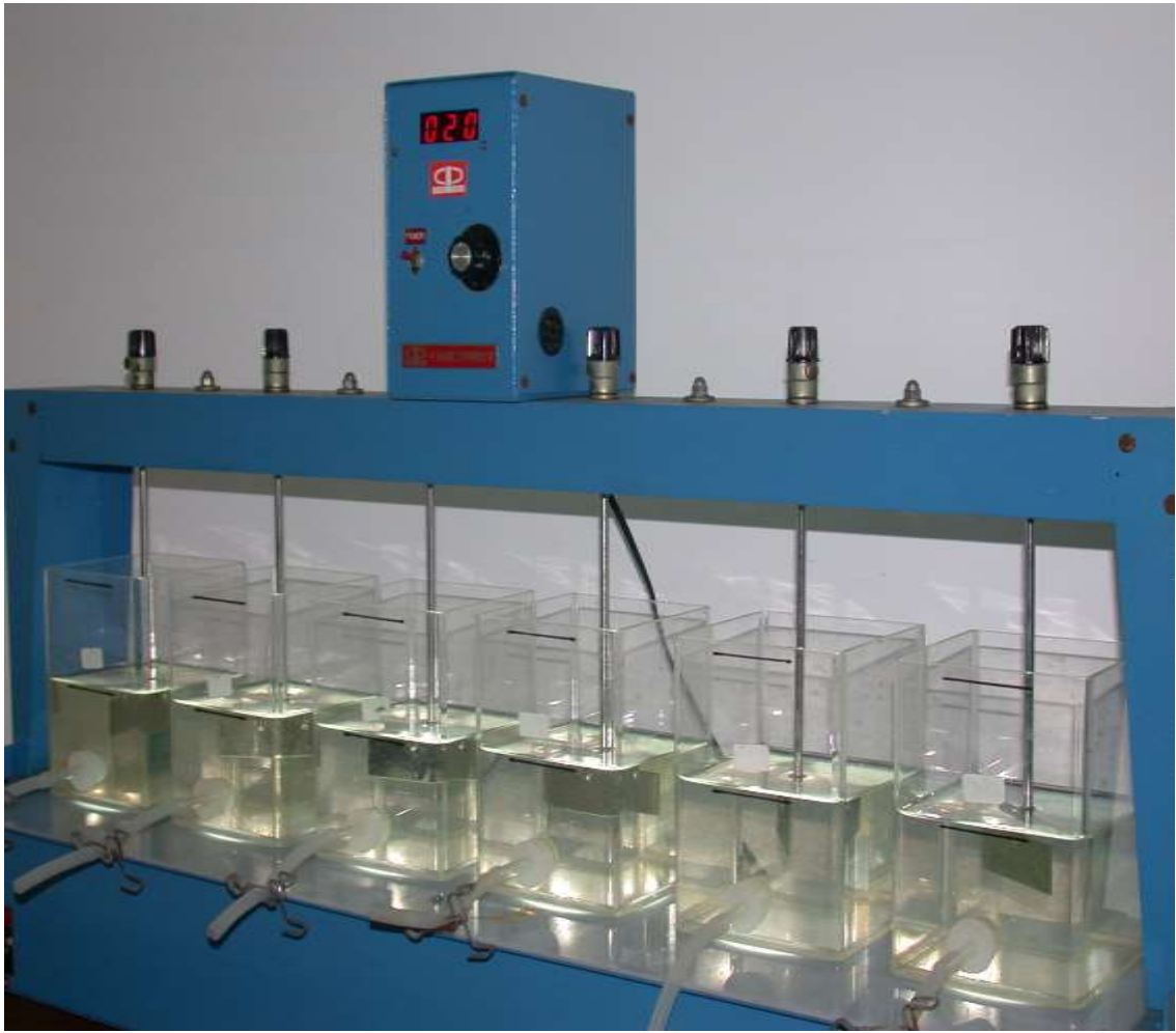
圖一：混凝試驗攪拌機
